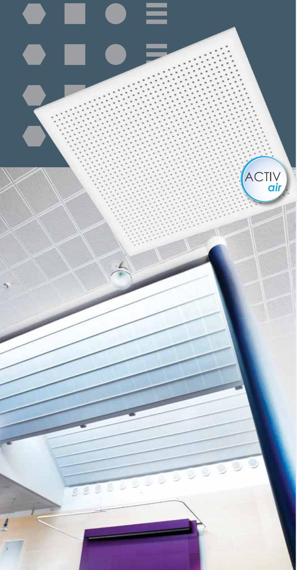
Gyptone Point 11 er et produktprogram fra Gyproc med runde huller som standard. Pladerne fremstilles i 5 forskellige kantudformninger til både synligt og skjult skinnesystem. Pladerne har gennemgående huller, som i kombination med den bagvedliggende akustikdug, giver gode akustiske egenskaber.
