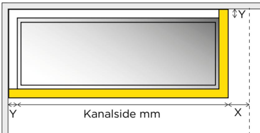
**X** er afstand til sidevæg og til tilstødende færdig-isoleret installationsdel.
