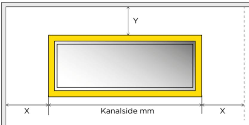
**X** er afstand til sidevæg og til tilstødende færdig-isoleret installationsdel.
