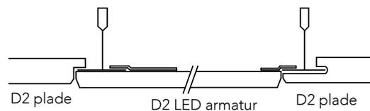
Kant D2 gipsplader og D2 LED armatur monteret direkte i skinnesystem.
