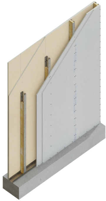
Indervægstype XR 70 (450) R k N k -N k R k MR System Gyproc XR 450
