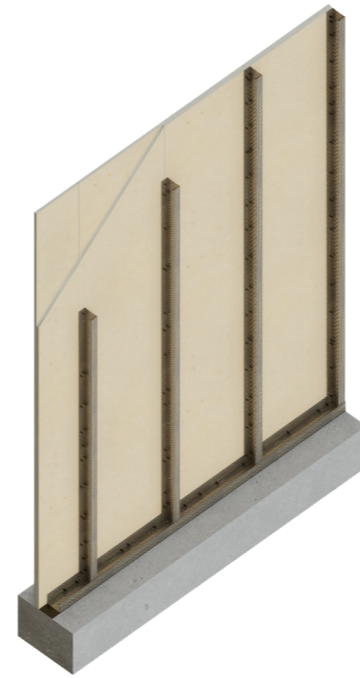
Indervægstype GS 70 (450) N k N k -0 M0 System Gyproc GS 450
